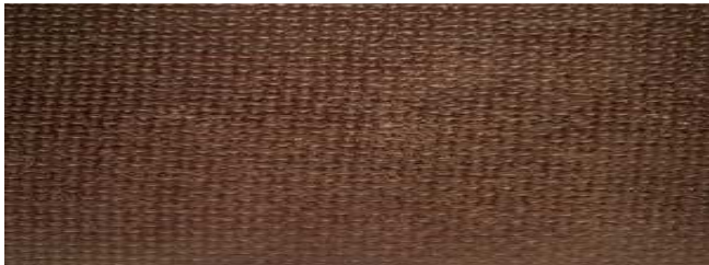
Siebseite einer Siebdruckplatte (rauhe Seite)
