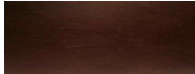
Filmseite einer Siebdruckplatte (glatte Seite)
