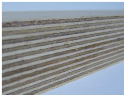
Schichtweiser Aufbau einer Birke-Multiplexplatte
